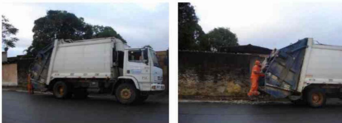
Figura 43 - Veículos para coleta de RSU
