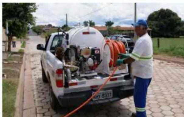
**Figura 34 - Equipamentos para manutenção de redes de drenagem**
